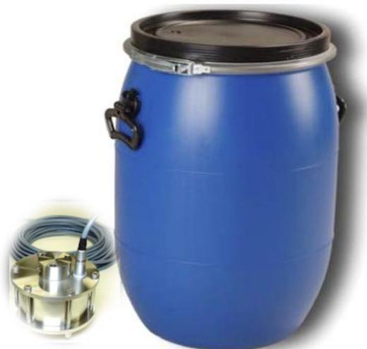
Dans le bidon de 60l est versée la solution mère à laquelle est additionné 20l d'eau provenant de l'exsurgence. La solution étalon ainsi obtenue est de :
