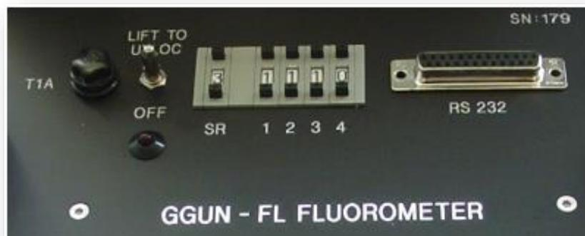
Après avoir bien essuyé le fluorimètre avec du papier essuies tout, le plonger dans la solution étalon. Laisser se stabiliser les mV à la valeur de la solution étalon C<sub>1</sub> soit 5g/l. ou 0,000005kg/m<sup>3</sup>. Cette opération terminée, plonger le fluorimètre dans l'exsurgence sans arrêter le datalogger.
