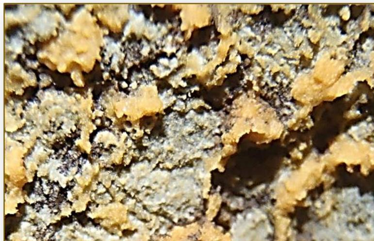
**ALTERATION DE LA PYRITE** Formation de petits agrégats de cristaux jaunes de copiapite  $(\text{Fe}^{2+}(\text{Fe}^{3+})_4(\text{SO}_4)_6(\text{OH})_2 \cdot 20\text{H}_2\text{O})$  par oxydation humide de la pyrite
